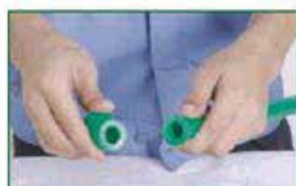
8. Fitting berulir digunakan pada sambungan ulir. Sambungan fitting berulir tidak boleh berpasangan dengan komponen plastik. Ulir harus dilapisi dengan seal teflon atau sealing compound.
